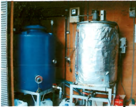
有用微生物群の培養器200リットル、400リットル ボランティア・中学生の参加によるダンゴ作り、10000個完成
